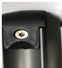
EMP シートレール (T8) オール長さ調節部 (T20) T(数字)がネジの大きさです。パーツによってトルクス穴の大きさ・数字が異なりますのでご注意ください。
