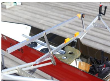
リガーの干渉を避けて直読でき、また1個のネジで固定できます。
