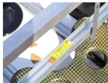
上下のバーに気泡管があり水平器としても使え、常に平行性を確認できます。
