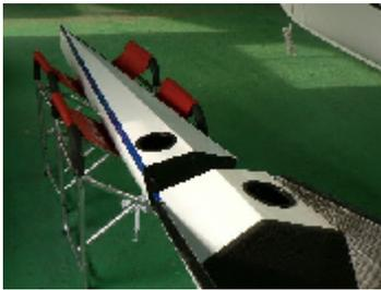
国産のレース艇である A1 艇で新たなチャレンジです。テールキャンパスで分割した 4X+ が完成しました。分割艇では分割した部分の強度を保つこと、また接合部分が正確に繋がる組立精度が必要になってきます。FISA ルールでは 12m 以下のボートに分割の義務はありませんが、今回は運搬の際の利便性を目的に分割のご注文をいただきました。また現在、堅田工場では通常より 3mm 厚い 8mm のハニカムを使用した A1・4X/-艇も製造中です。剛性は厚みの影響を大きく受けるため、従来のもより大幅な剛性アップが期待されます。この艇ではラダーの取付位置を変更し、フィンラダーとしていることも新しい試みです。完成次第、Boat Times でもご紹介したいと思います。
