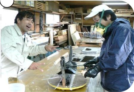
新米社長・工場見学シリーズ第二弾は、木工室の紹介です。ここでは細かな部材を作っています。木工といってもカーボン艇になり、木材以外の部材も扱うようになっていきます。例えばリブ(リガーフレーム)。樹脂を含浸させたカーボン繊維を積層して作りますが、山田さんが大きなピンセットを両手に、ターンテーブルに載った型に、素早く繊維を貼っていきます。まるで何か料理を作っているような、まさに職人ワザ！いやもっと何かに似ているなあこの姿…あっバルタン星人だ！「フオッフオッフオッフ」と山田さん(…は作業中なので社長の相手をしているヒマはない。ゴメンなさい)この後は治具をセットして余分な樹脂を絞り出し加熱硬化させます。造船工程は細かく見ていくと面白いことがたくさんあります。次回もお楽しみに！【小沢】
